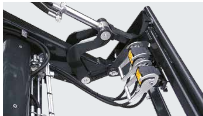
For en enda raskere forbindelse av de hydrauliske ledningene finnes Hydro-Fix også for verktøymontering.
